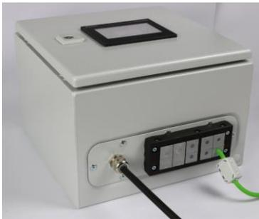
**Bild 2+3:** Die SCM Kits bestehen aus einem Schaltschrank mit Sensor-Controller, Bedienanzeige und einem vorkonfektionierten Schwingungssensor und können auf bis zu 6 bzw. 14 Sensoren erweitert werden. Die Inbetriebnahme erfolgt einfach über Plug&Play mittels Bedienanzeige. SmartCheck Sensoren können bei Bedarf genau dort, wo sie benötigt werden, in Maschinen eingebaut werden.
