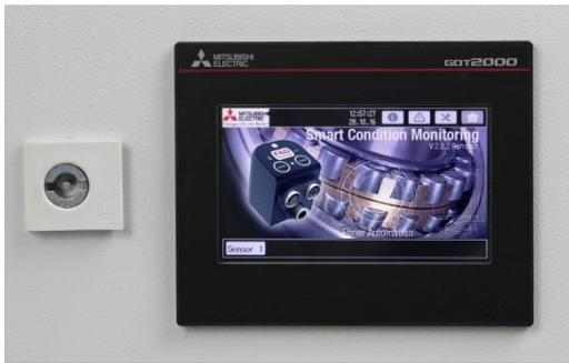
**Bild 4:** Das SCM ermöglicht eine Analyse mit detaillierter Diagnose. Die vom Schwingungssensor ermittelten Daten werden im Sensor-Controller aufbereitet und an der Bedienanzeige als Status oder Klartextalarm mit Wartungsmaßnahme angezeigt, durch die dann eine Wartungsaktion zeitlich geplant werden kann.
